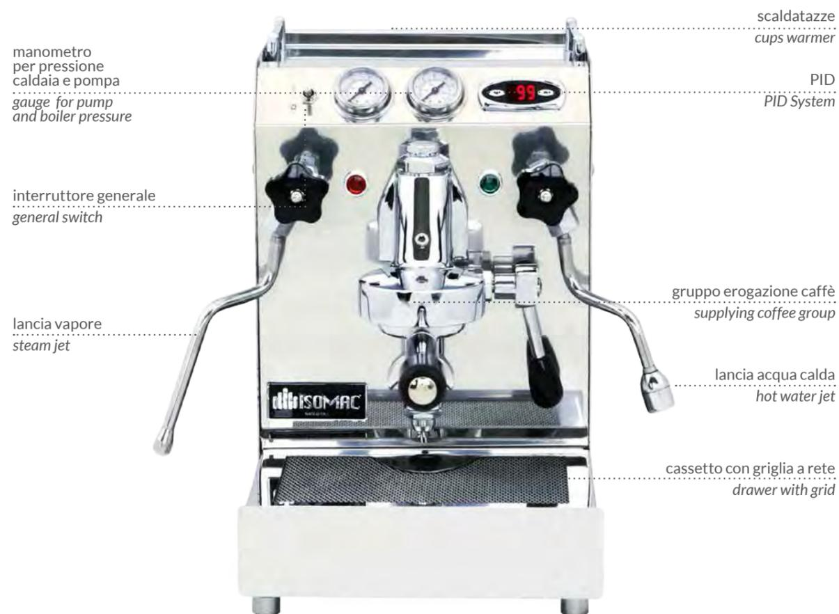
Macchina per caffè espresso e cappuccino, costruita con i componenti delle macchine commerciali per bar. dotata di un dispositivo cronoelettronico che consente la regolazione ed il controllo della temperatura garantendo la stabilità termica dell'erogazione acqua per differenti miscele di caffè e per l'erogazione vapore.
